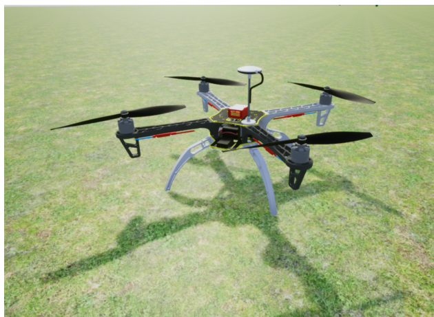
图 6-1 仿真软件 RflySim3D 利用物理引擎对 F450 无人机的建模
